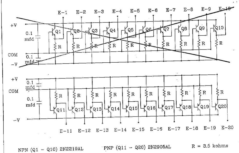
X128 TRANSISTOR RADIATION TEST CIRCUIT
