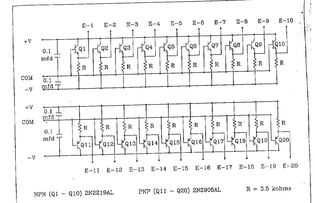
X128 TRANSISTOR RADIATION TEST CIRCUIT
